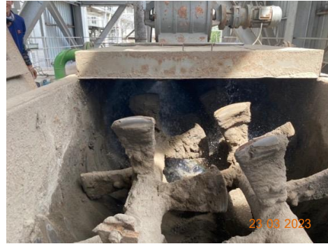
ภาพที่ 2-8 การฉีดพรมน้ำเพื่อลดการฟุ้งกระจายของเถ้า
